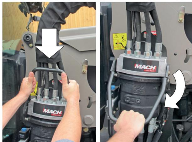
2. Den Hebel nach vorn drücken bis in die bewegliche Position + den Schlepper vorfahren. Gegebenenfalls die Räder einschlagen.
