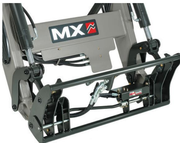
**Hinweis:** Wenn das Werkzeug mit einer oder mehreren Hydraulikfunktionen ausgestattet ist, zunächst die Hydraulikschläuche entfernen.
