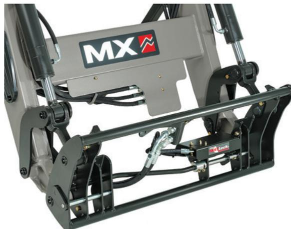
**Hinweis:** Wenn das Werkzeug mit einer oder mehreren Hydraulikfunktionen ausgestattet ist, die Hydraulikschläuche anschließen.
