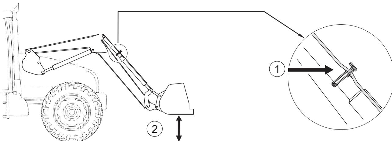
(1) Anzeige (2) Schaufel parallel zum Boden
