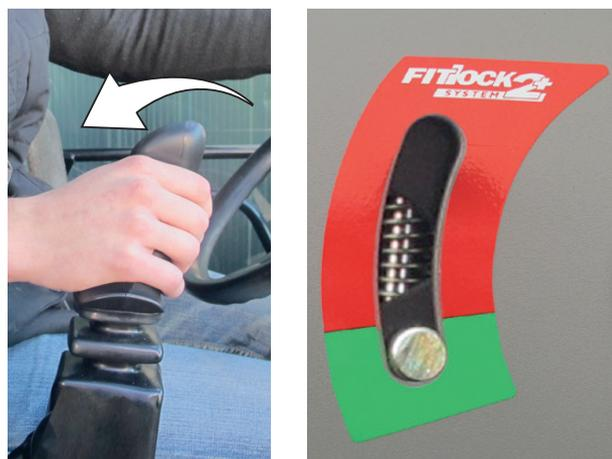
4. Die Abstellstützen links und rechts einklappen und verriegeln.
