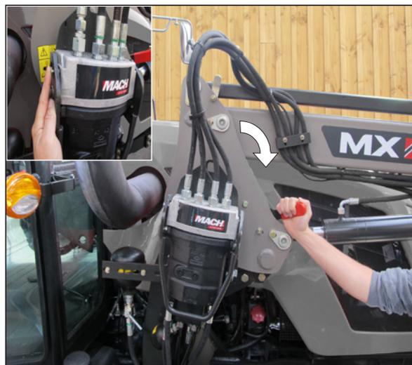
— Desconecte los sistemas hidráulico y eléctrico. Pala cargadora con MACH System:
