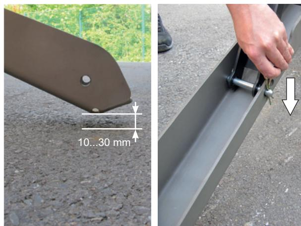
— En el lado derecho, tire hacia abajo de la empuñadura de desbloqueo.
