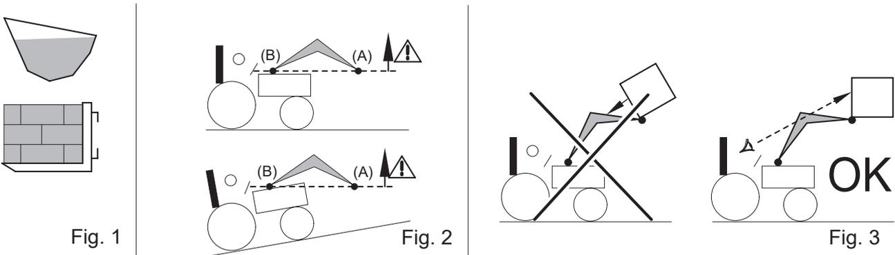
**⚠ PELIGRO:** Si la carga no está correctamente asegurada, el operario corre el peligro de que la carga se caiga cuando el punto de pivote del implemento (A) sobrepase la horizontal del punto de pivote de la pala cargadora (B) (consulte la fig. 2).
