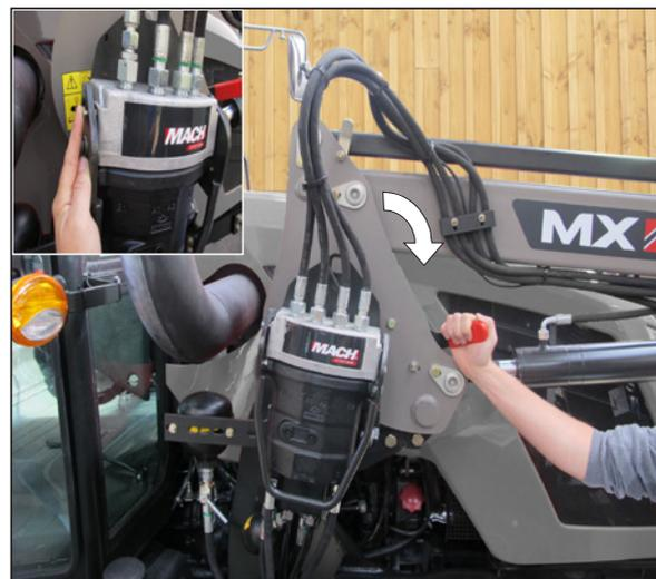
— Scollegare i sistemi idraulico ed elettrico. Caricatore con MACH System:
