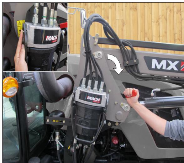
— Desligue os sistemas hidráulico e elétrico. Pá carregadora com sistema MACH:
