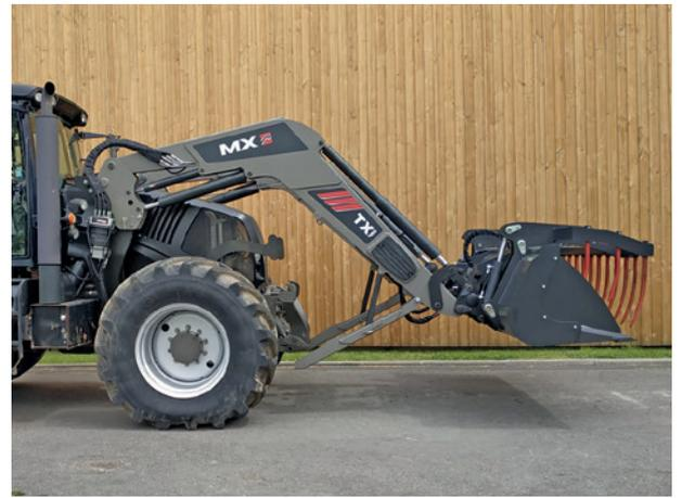
— Den Rahmen des Frontladers mit den Bolzen an der Anbaukonsole verriegeln.
