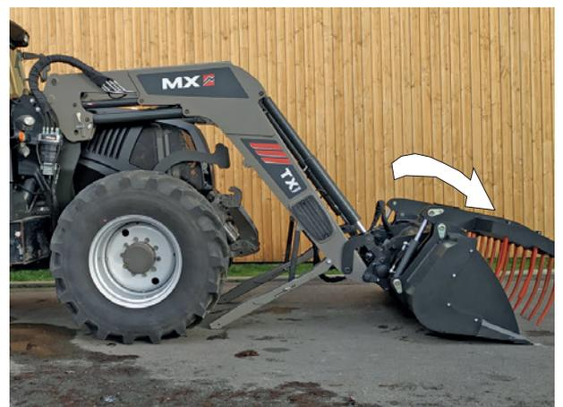
— Den Frontlader bis 0,5 m über dem Boden anheben.
