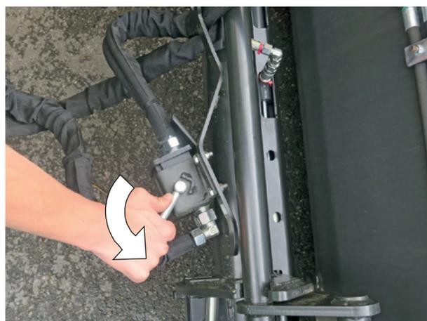
— Coloque los latiguillos en la parte delantera del implemento.
