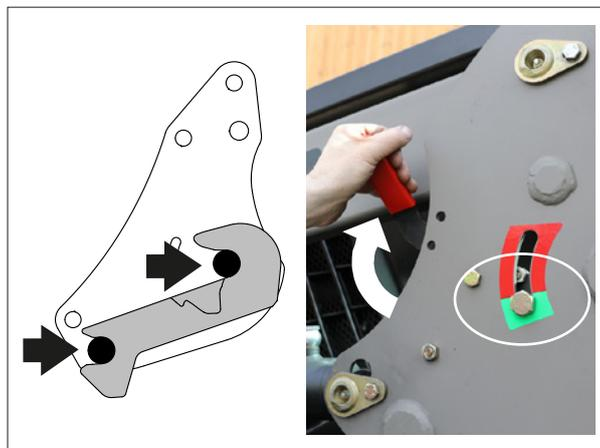
**5.2.5** Cuando la pala cargadora está enganchada, las palancas de desbloqueo deben estar en la posición indicada, como se muestra a la derecha.
