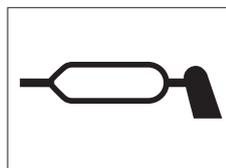
**⚠ ВНИМАНИЕ!** Вытекающее под давлением масло может иметь достаточную силу, чтобы проникнуть под кожу и вызвать серьезные травмы. Прежде чем отсоединять шланги, обязательно сбросьте все давление. Прежде чем подавать давление в систему, убедитесь, что все соединения затянуты, а шланги и гидравлическая система не повреждены.
