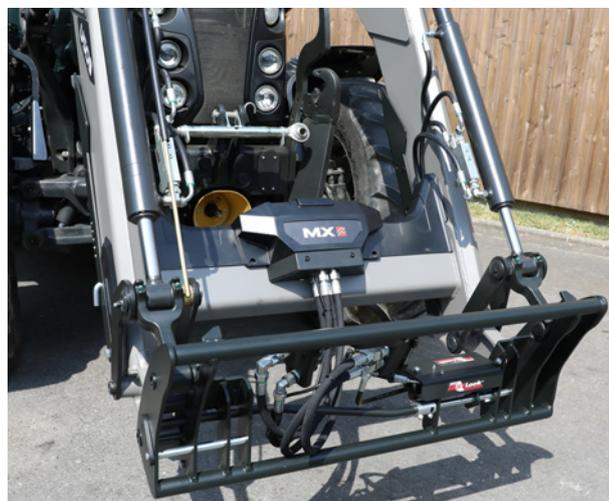
ПРИМЕЧАНИЕ. Если рабочий орган оснащен одной гидравлической функцией или несколькими, следует начать с отсоединения шлангов.
