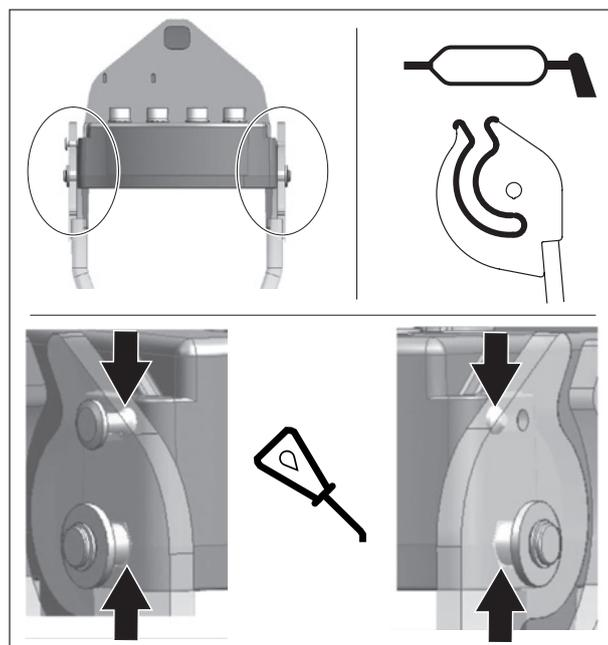
Наносите смазку каждые 10 часов и после каждой мойки (**вода смывает смазку**), особенно после мойки с использованием аппарата высокого давления.
