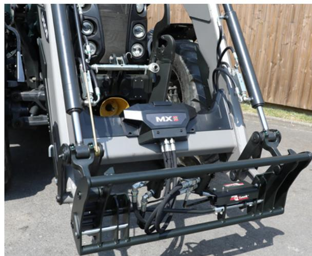
ПРИМЕЧАНИЕ. Если погрузчик оснащен одной гидравлической функцией или несколькими, следует подсоединить шланги.
