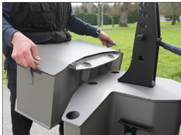
— Asegure la Multibox XS con el tornillo y la arandela.
