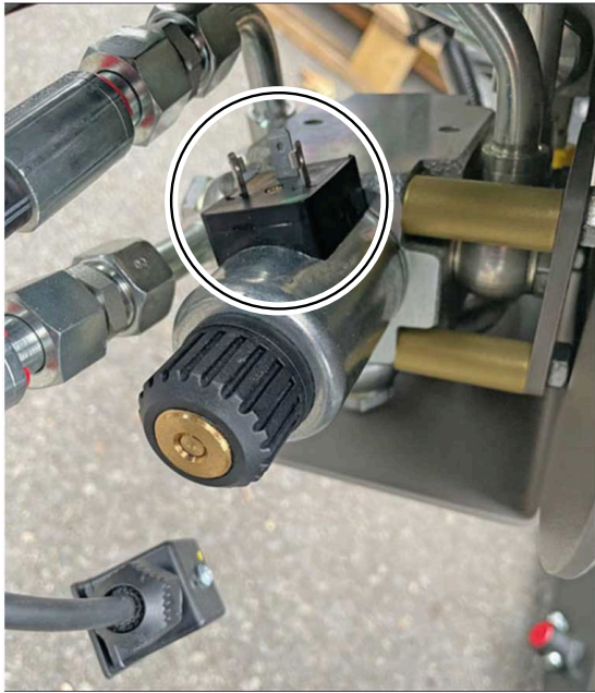
Électrovanne de 3ème fonction sur le chargeur C400PRO.
