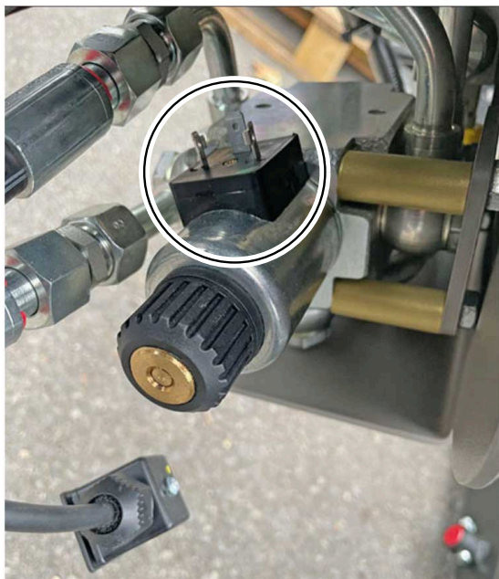
Elektrozawór 3. funkcji na ładowaczu C400PRO.
