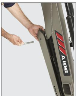
Die Abstellstützen in den Arm des Frontladers integriert sind in. Wenn sie zusammengeklappt sind, bilden sie ein Schutzgehäuse für die Hydraulikschläuche.
