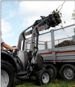
Einer der großen Vorteile der Frontlader MX COMPACT besteht darin, eine sehr kompakte Einheit aus Schlepper-Frontlader zu bewahren und dabei gleichzeitig ein einfaches Auskippen von Material in Anhänger oder ein einfaches Aufeinanderstapeln von Paletten zu ermöglichen.
