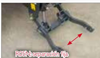
En función de los tractores, se puede usar un tripuntal con separación fija (R05N / R08N).
