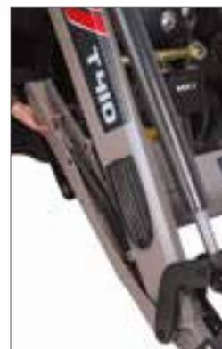
Pies de apoyo protegidos e integrados en el brazo de la pala. Incorporan un mecanismo de bloqueo y desbloqueo rápido y sencillo sin necesidad de bulones.
