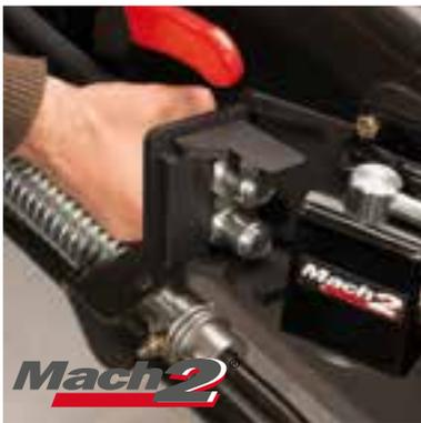
Conexión hidráulica rápida pala
