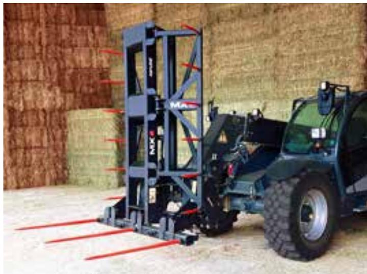
Sistema hidráulico necesario: 1 función.
