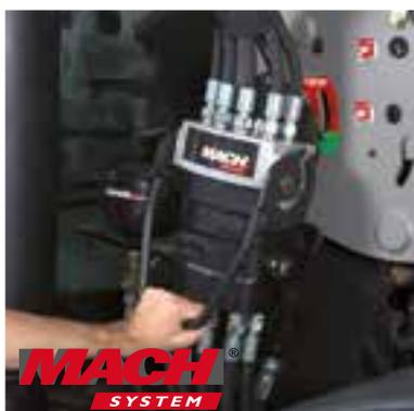
Conexión electrohidráulica rápida
