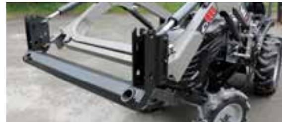
El cuadro portaherramientas es una opción que permite cambiar muy fácilmente de implemento, con un simple alzado manual. Está preparado para la instalación de 2 púas MANUBAL o incluso de las horquillas TRC500 para la manipulación de sus palés.
