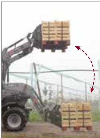
Los pies de apoyo, completamente integrados en el brazo de la pala cargadora, cuentan además con un mecanismo de bloqueo y desbloqueo sencillo y eficaz mediante bulón.
