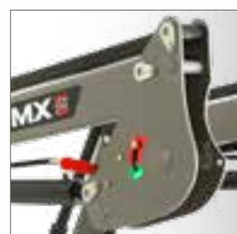
100 % de los puntos de articulación protegidos por casquillos bimetálicos y provistos de un sistema antirrotación de plano axial para una duración máxima.
