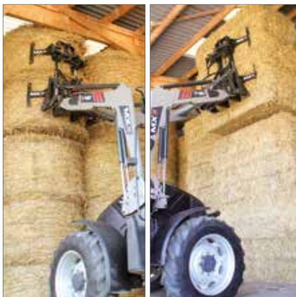
Sistema hidráulico necesario: 1 función • Altura mínima de elevación de la pala cargadora frontal: 3,60 m en el pivote • Potencia equivalente o superior a la del modelo MX U410/T410.
