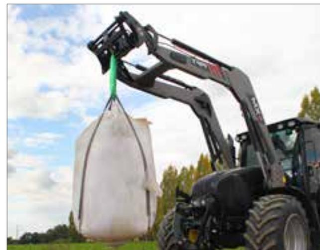
Dispositivo de seguridad obligatorio para la elevación y la descarga.
