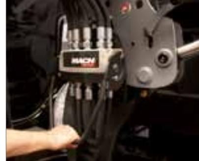
Conexión electrohidráulica tractor / pala cargadora con acoples estancos provistos del MACH System®. [▶ página 50](#)
