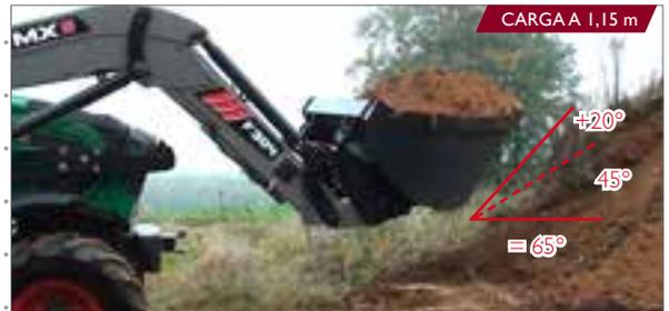
Reserva de carga: +20° de reserva de carga a 1,15 m de altura gracias a la cinemática de la pala cargadora y las dimensiones de los cilindros de descarga.
