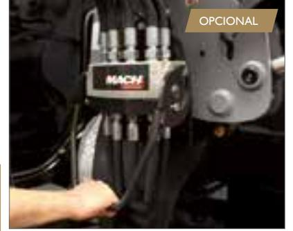
Conexión electrohidráulica tractor / pala cargadora con acoples estancos provistos del MACH System®. > página 50
