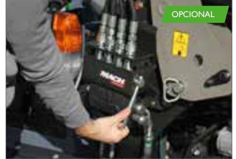
Conexión electrohidráulica tractor / pala cargadora con acoples estancos provistos del MACH System® \*
