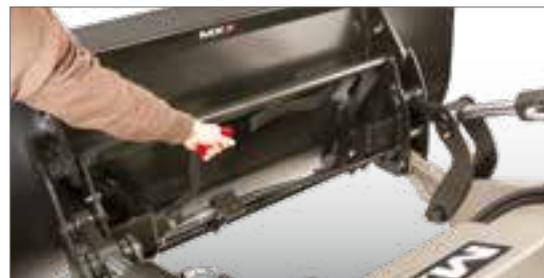
Cuadro portaherramientas con bloqueo automático. Empuñadura de desbloqueo accesible desde el exterior.
