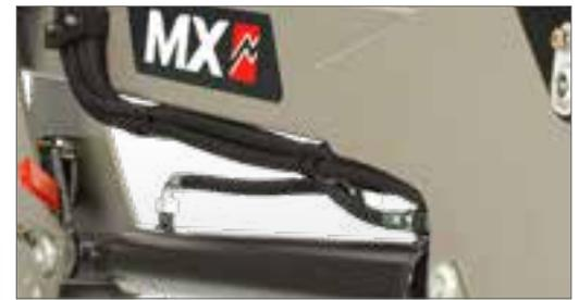
Los latiguillos hidráulicos y el cable eléctrico de poliuretano pasan discretamente bajo los brazos de la pala cargadora, manteniéndose protegidos, limpios y fácilmente accesibles.
