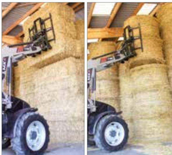
Sistema hidráulico necesario: 1 función • Altura mínima de elevación de la pala cargadora frontal: 3,60 m en el pivote • Potencia equivalente o superior a la del modelo MX U410/T410.
