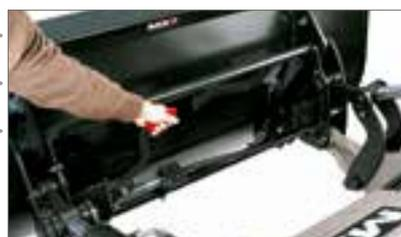
Cuadro portaherramientas con bloqueo automático. Empuñadura de desbloqueo accesible desde el exterior.
