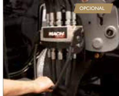
Conexión electrohidráulica tractor / pala cargadora con acoples estancos provistos del MACH System®.
