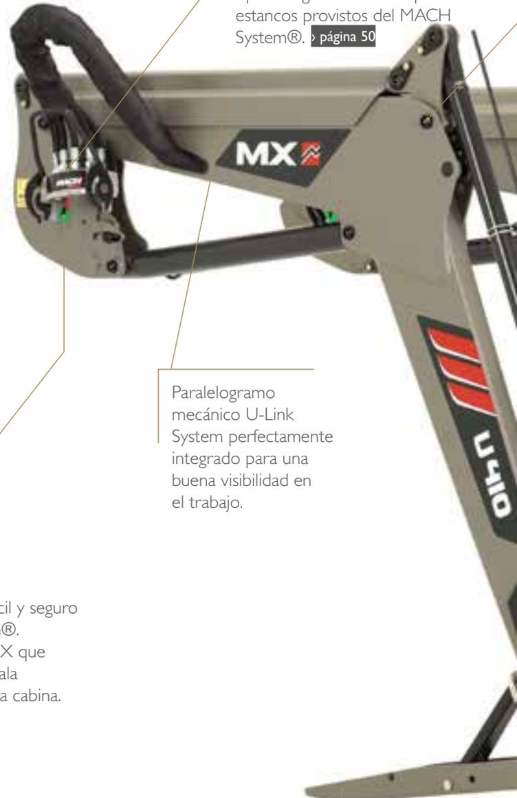
Paralelogramo mecánico U-Link System perfectamente integrado para una buena visibilidad en el trabajo.
