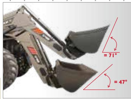
Ángulo de carga que ofrece un rendimiento máximo de hasta 71° a 1,20 m del suelo.
