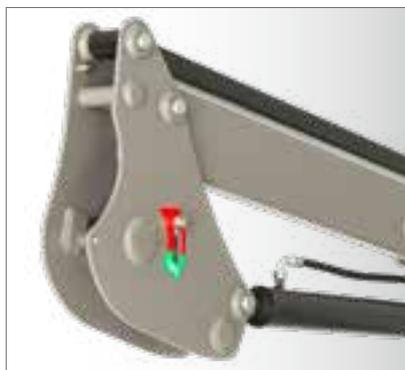
Enganche y desenganche fácil con el FITLOCK 2M System®. Sistema desarrollado por MX que permite quitar o poner la pala bajándose solo una vez de la cabina. Bloqueo manual.
