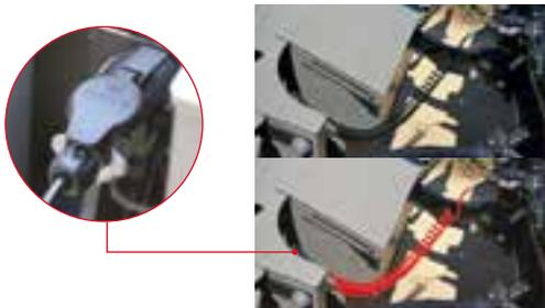
Prise 7 broches intégrée et fournie avec câble spirale mâle/mâle de 3 m pour une connexion propre et sûre.
