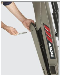
Bene integrate nel braccio del caricatore. Ripiegati, formano un carter che protegge i flessibili idraulici.
