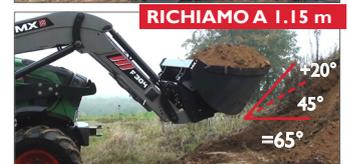
Capacità di richiamo: +20° di capacità di richiamo a 1,15 m di altezza grazie alla cinematica del caricatore e al dimensionamento dei cilindri di bennaggio.
