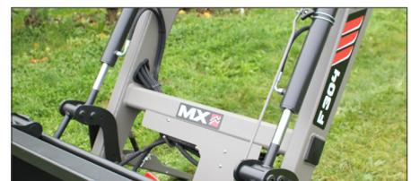
Il blocco è posizionato sotto la traversa, garantendo così un'ottima visibilità dalla cabina. Integra due valvole di ritegno (limitatore di pressione doppio) di serie e l'elettrovalvola di 3ª funzione (3ª funzione opzionale).
