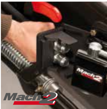
Directe hydraulische aansluiting lader ↔ werktuig
