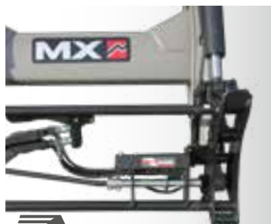
Automatische koppeling/ ontkoppeling van werktuigen en hydraulische en elektrische functies
